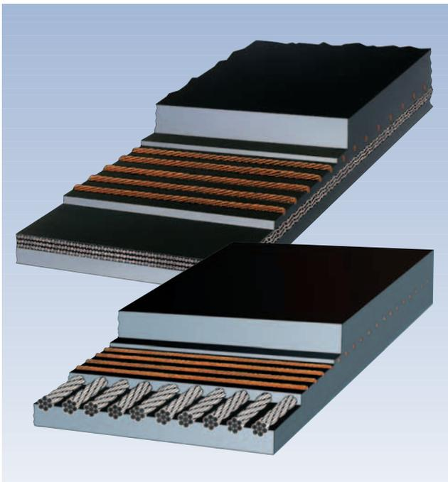
**Fig. 10:** correa transportadora con capas de tela (arriba) y con cables de acero (abajo), reforzada con refuerzo transversal PHOENOTEC®.
